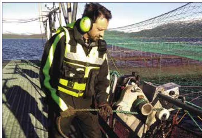
Portable Winch PCW-5000 i bruk i oppdrettsnæringen. Foto: Johan P. Andreasson
