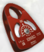
CE PCA-1292 Enkeltsvings siderem - hele i aluminium. 1 trinse 63 mm dia. For tau opp til 13 mm dia. MBS: 50 kN
