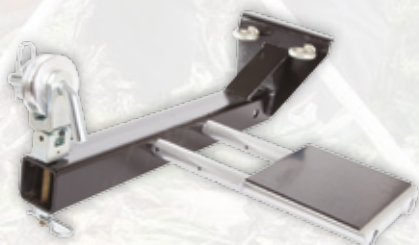
PCA-1805 Vinsjefestet for feste til underlag er spesielt utviklet for å trekke ledning gjennom rør som kommer ut av en el-tavle, og hvor ingen andre festepunkter er tilgjengelige.
