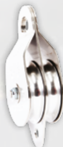
PCA-1273 Dobbeltsvings siderem med plater i rustfritt stål. 2 aluminiumtrinser 100 mm dia. For tau opp til 13 mm dia. WLL: 44 kN
